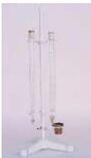
Instrumento empleado para medir indirectamente la humedad relativa del aire. Está formado por dos termómetros, cuyos depósitos se mantienen, el uno seco y el otro mojado cubierto por una película fina de agua pura o hielo. Fue diseñado por Augustus en 1825.
